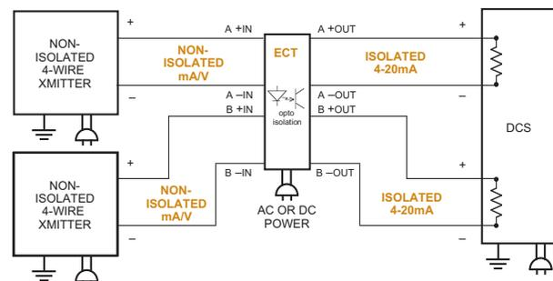
NOTE: ONLY 16V TX EXCITATION PROVIDED ON 2X4-20MA DUAL INPUT MODEL
